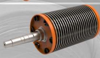
РОТОР 3591.02.100СБ МОЛОТКОВОЙ ДРОБИЛКИ СМД-97А
